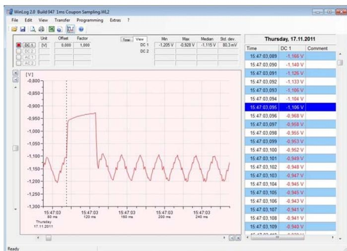
Echantillonnage de coupon avec le MiniCoup et 1ms de temps d'échantillonnage
