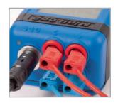
а их активные фильтры низких частот позволяют предотвратить влияние помех переменного напряжения. MiniLog2 имеет память для сохранения 1.300.000 измерений (версия: 4 МВ, опция: 16 МВ). Даже во время самых быстрых измерений (1000 измерений / сек.) регистрация данных может длиться беспрерывно в течение 20 минут. Передача измерений на ПК выполняется через встроенный USB-интерфейс с гальванической развязкой.
